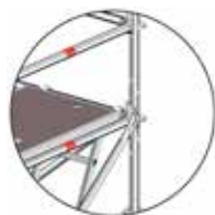
Illustration 85 : assemblage du mon- tant vertical à l'aide d'un raccord boulon et de 2 + 2 boulons
