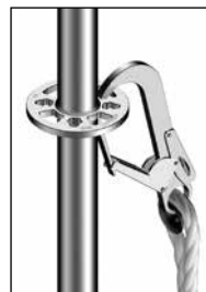
Illustration 10 : possibilité d'amarrage par les petites ou les grandes ouvertures de la rosace (uniquement possible sur les échafaudages Allround en acier, pas en aluminium !)
