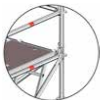
Illustration 84 : assemblage du mon- tant vertical à l'aide d'une goupille d'arrêt
