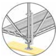
Illustration 83 : fixation du socle avec tête à clavette
