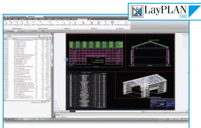
Creëren van steigerconstructies met integrale materiaallijsten.
