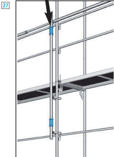
2. Serrer / desserrer montage-balustre en tournant la poignée de dessous
