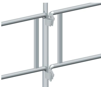
Posez les garde-corps dans les colliers de façade et fixez-les en frappant les à l'aide d'un marteau.
