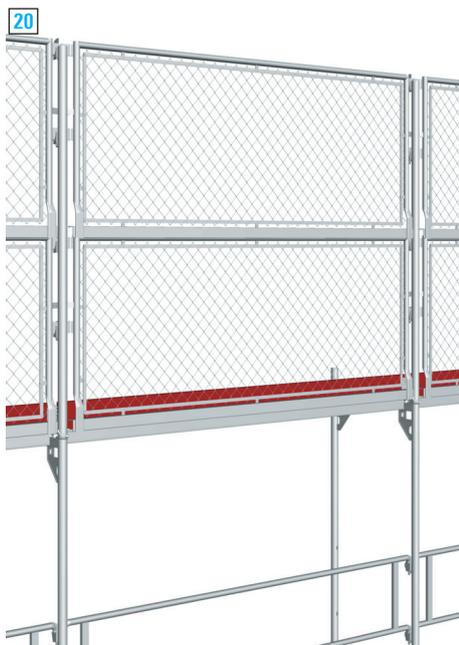
**21** Montez des supports grillage de protection, si des débris risquent de tomber de l'échafaudage. Amarrez le support grillage de protection aussi bien en haut qu'en bas et couvrez-le de planchers. Les cadres, auxquels les supports grillage de protection sont montés, doivent être ancrés à la construction.
