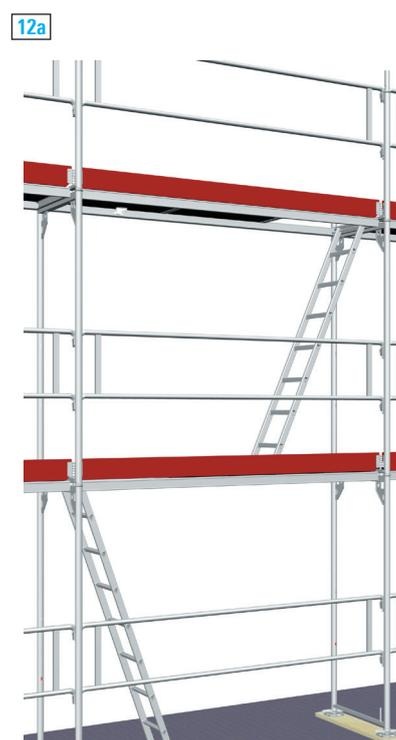
**12a** Les planchers à volet peuvent exclusivement être montés l'un au dessus de l'autre, de sorte que l'échelle d'accès installée protège l'ouverture. Montez tous les niveaux de travail suivants dans le même ordre, en commençant toujours par l'échelle d'accès inférieure.
