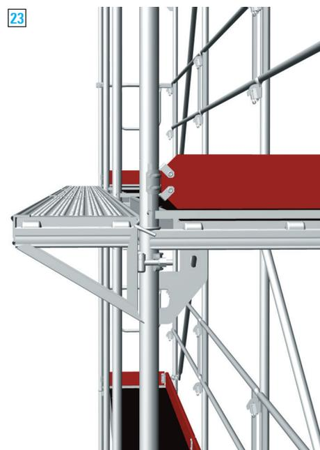
Les consoles de 0.73 m ne peuvent dépasser une charge de 150 kg/m<sup>2</sup> cependant si la console est soutenue par un étaçon supplémentaire, une charge de 200 kg/m<sup>2</sup> est permise.
