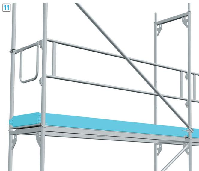
**11** Il faut installer des plinthes aux niveaux de travail supérieurs à 2.5m. Pointez les plinthes sur le goujon du cadre. Posez également les plinthes de tête.
