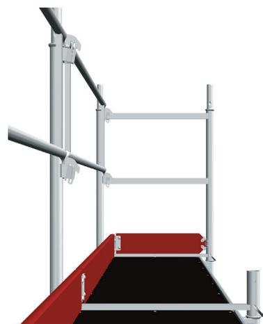
Accouplez le support garde-corps et le cadre avec sous-lisse avec un double garde-corps et verrouillez avec des goupilles. De cette façon, vous verrouillez les planchers du lieu de travail supérieur contre l'enlèvement ou le soulèvement par le vent.
